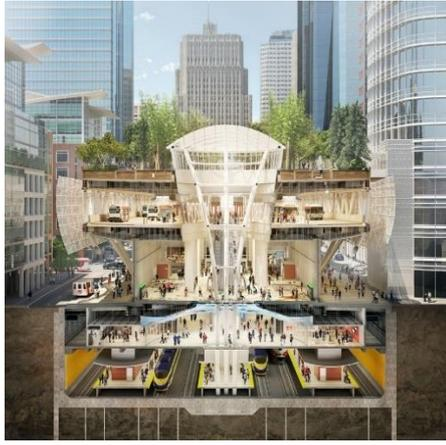
Рисунок 21. Транспортный хаб в Сан-Франциско. Терминал в разрезе. [9]
