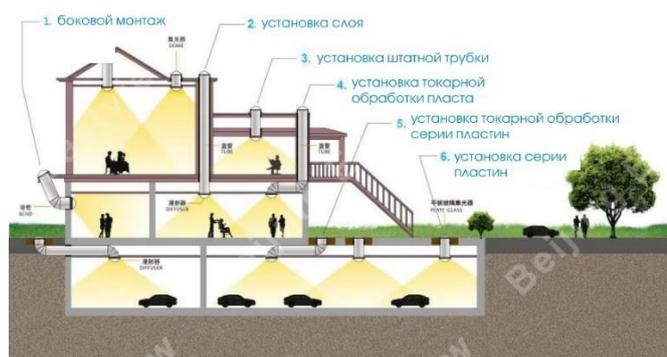
Рисунок 27. Способы установки трубчатой системы дневного освещения. [13]
