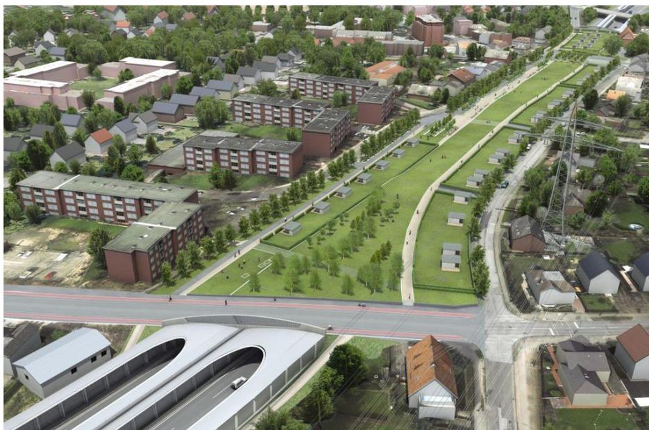
Рисунок 18. Визуализация проекта Hamburger Deckel шоссе Автобан 7 в Гамбурге (Германия). [6]
